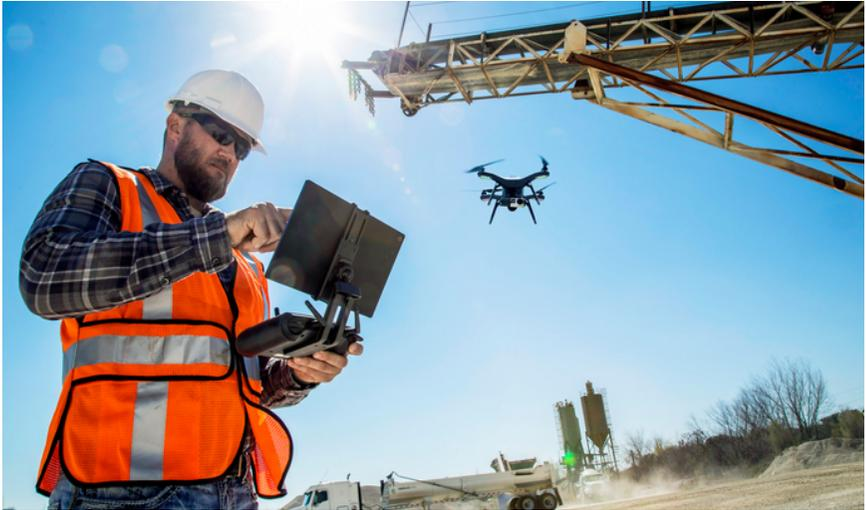
Es un vehículo aéreo no tripulado (VANT), UAV (del inglés unmanned aerial vehicle) o comúnmente conocido como Drone es una aeronave que vuela sin tripulación. Un VANT es un vehículo sin tripulación capaz de mantener de manera autónoma un nivel de vuelo controlado y sostenido, es propulsado por un motor de explosión, eléctrico o de reacción.
