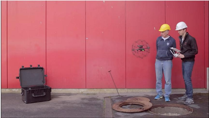
La empresa **Flyability** desarrollo un Drone que realiza inspecciones en espacios confinados. [Elios 2](#) es un Drone de Inspección intuitivo, fiable y preciso que mantiene a las personas fuera de peligro mientras realiza Inspecciones para recopilar Datos del espacio confinado.
